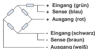
Elektrische Anschlüsse Schematische Darstellung (symmetrische Brücken-Konfiguration)
