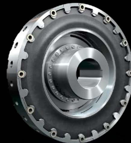
Hochdrehelastische Kupplung mit sehr hoher Verlustleistung. Für drehschwingungsaktive Antriebe. Übertragung des Drehmoments über ein verzahntes Außenteil auf ein in schlanke Scheiben geteiltes Gummielement. Durch eine vergrößerte Oberfläche, einen verkürzten Wärmeleitweg und eine effektive Belüftung für eine höhere zulässige Verlustleistung optimiert.
